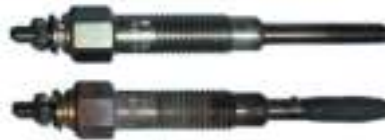
Bild 3. Oskadat glödstift (ovan) och ett skadat, kortslutet glödstift (nedan)
