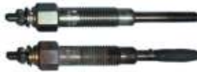
Bilde 3. Intakt glødeplugg (over) og glødeplugg skadet i kortslutning (under)
